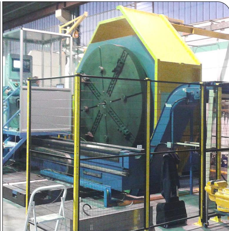
Revamping tornio con sostituzione motori e interfaccia encoder mandrino.
